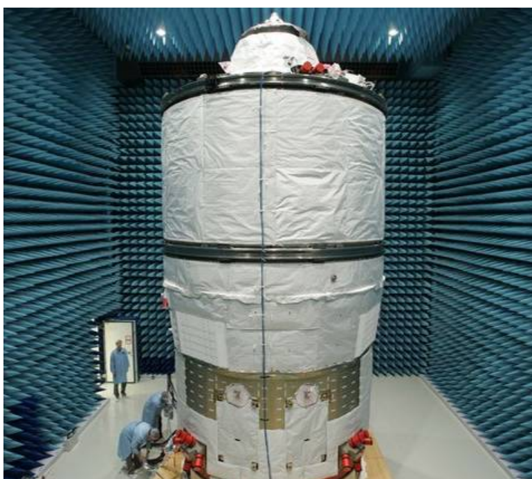
L'ATV Jules Verne dans la chambre EMC (ESTEC)
