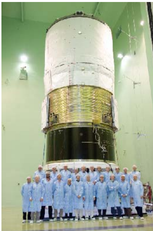
L'ATV « Jules Verne » dans la chambre acoustique de l'ESTEC (LEAF)
