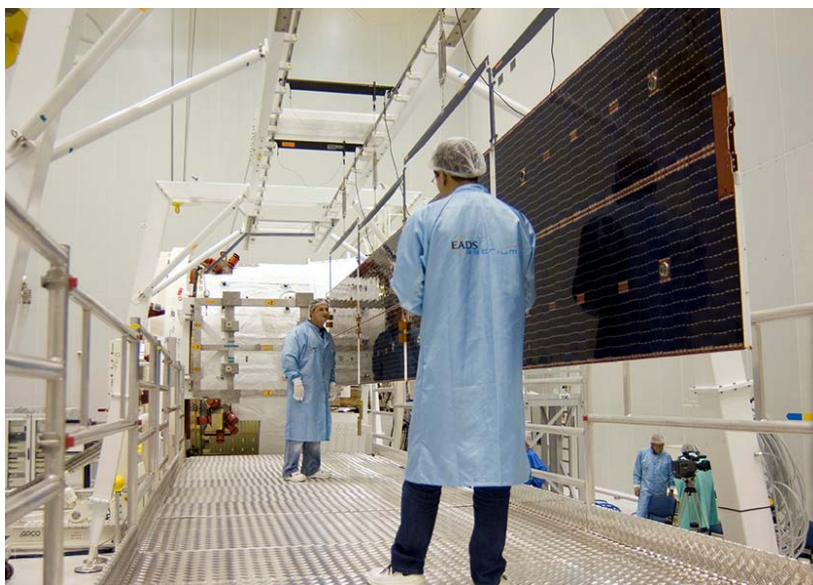
Intégration des générateurs solaires
