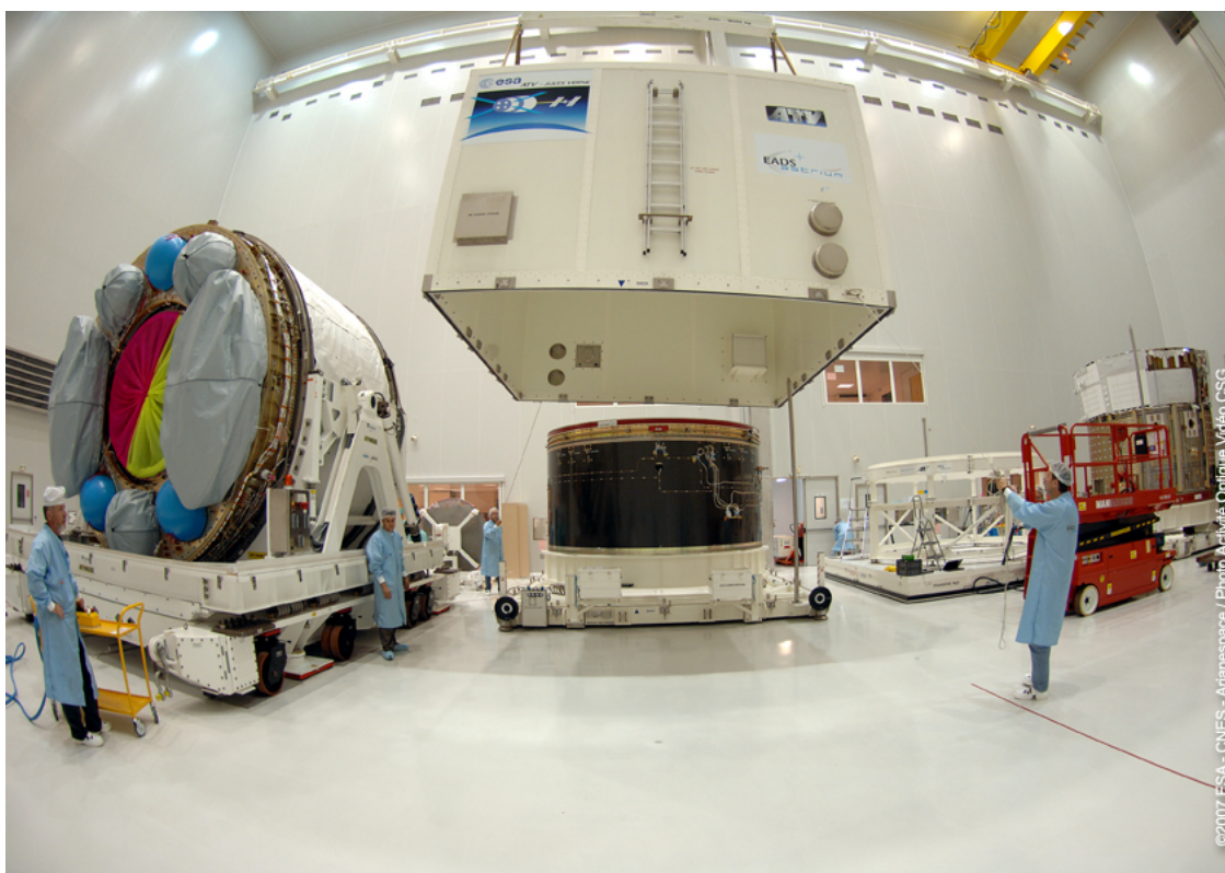
De gauche à droite : l'ICC, l'adaptateur SDM (en cours de déconditionnement) et le S/C
