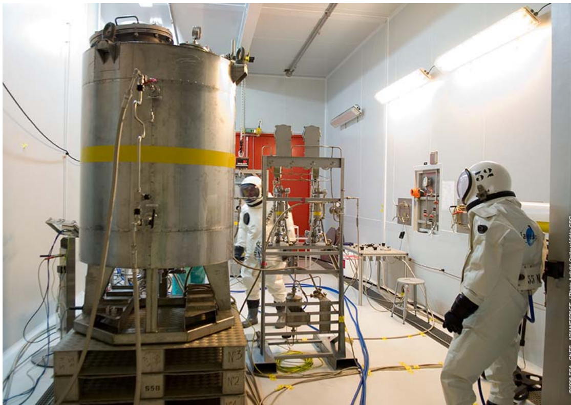
Opération de chargement des ergols (S5B)
